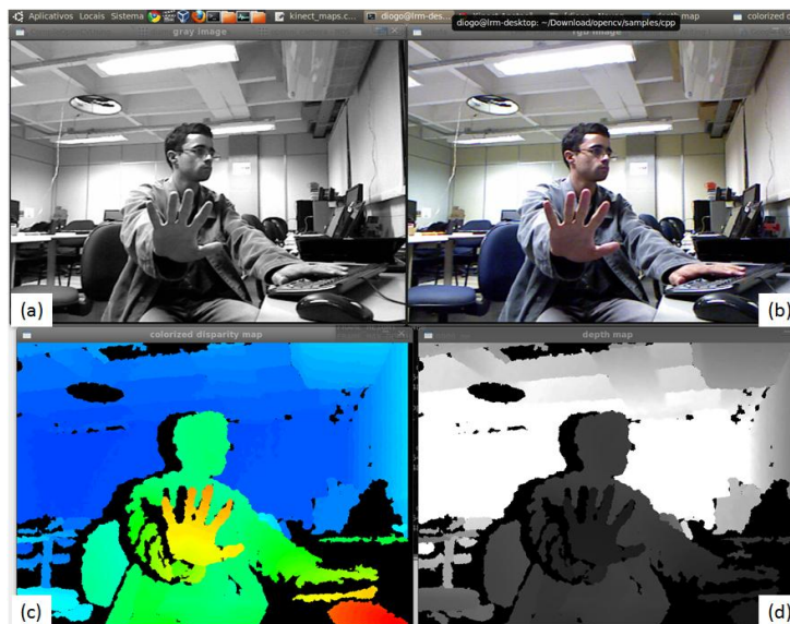
Figura 2. Sensor RGB-D do Kinect: (a) Imagem em Escala de Cinza; (b) Imagem RGB colorida; (c) Mapa de Profundidade com Falsas Cores; (d) Mapa de profundidade em Tons de Cinza (Lab. LRM/ICMC-USP)
