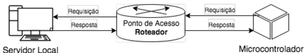
Figura 1. Topologia física da rede local.
