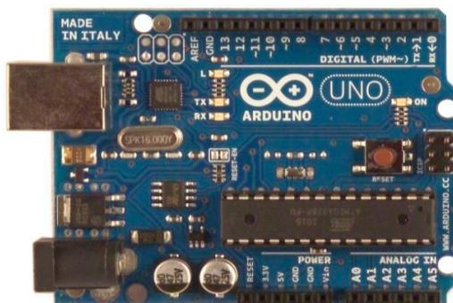
Figura 1: Plataforma Arduino Uno
