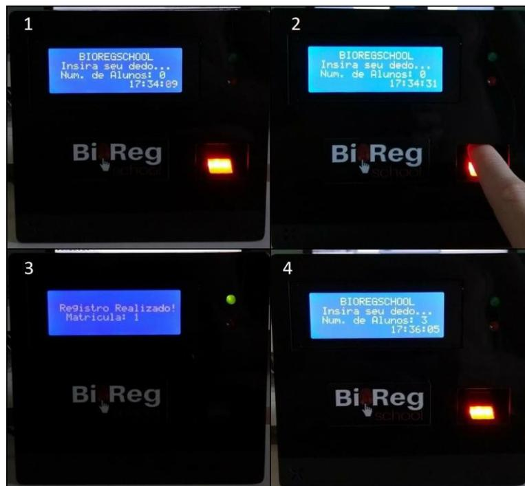
Figura 9. Modo Registro Módulo Biométrico
