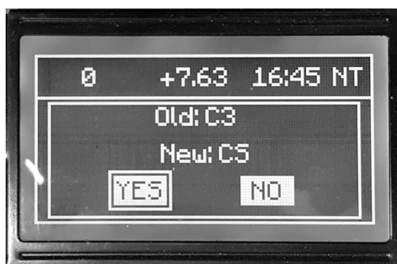
Figura 7. Exemplo da classe ConfirmMenu na interface LCD. A figura mostra um menu pedindo a confirmação da alteração do nome anterior para o novo, com a opção Yes em destaque.
