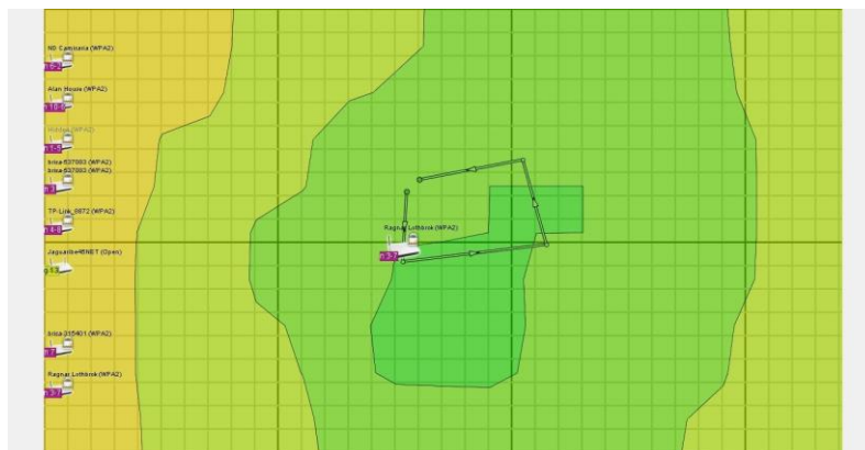
Figura 1. Exemplo de mapa de calor gerado pelo software Ekahau HeatMapper.
