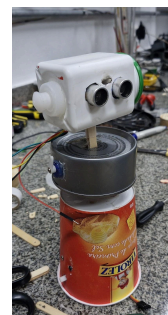
Imagem 1: Estrutura inicial de um dos robôs.
