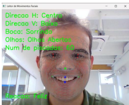
Figura 2: Janela de execução do programa, exibindo o rastreamento do rosto e a exibição das informações (Direção H: Centro; Direção V: Baixo; Boca: Sorrindo; Olhos: Abertos; Número de piscadas: 60)
