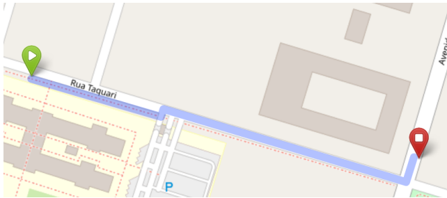
Figura 3: Rota traçada com a API Valhalla: desviando para a pista de rolamento (área em destaque sem pontilhado), apesar da calçada mapeada (linha pontilhada). (Fonte: Os autores)
