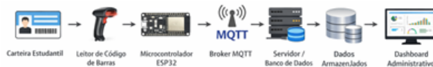
Figura 1: Arquitetura da solução IoT proposta para o controle de acesso ao refeitório universitário.
