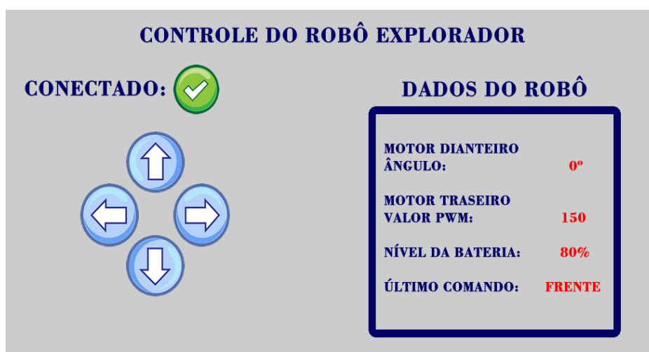
Figura 5. Interface do sistema de controle remoto do robô explorador
