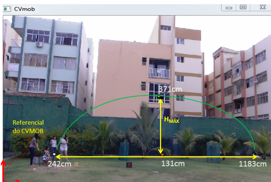
Fig. 6. Coordenadas obtidas pelo CVMob, para o cálculo do alcance e de altura máxima. De acordo com a figura, H = (371\text{cm} - 131\text{cm}) = 2,40 e A = (1183\text{cm} - 242\text{cm}) = 9,41\text{m} .
