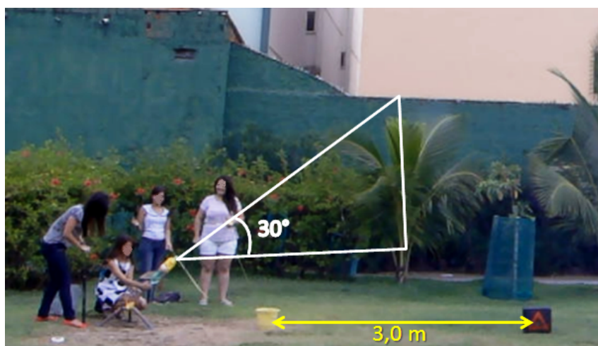
Fig. 4. Lançamento de um foguete feito com garrafa pet. O ângulo de lançamento foi ajustado para 30^\circ .
