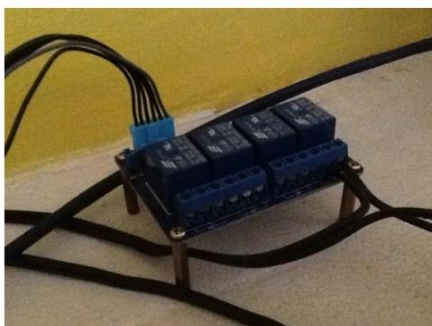
Figura 7 – Chaveamento com relé
