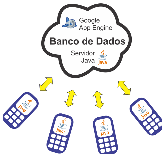
Figura 7. Arquitetura cliente-servidor do QuizQuiz
