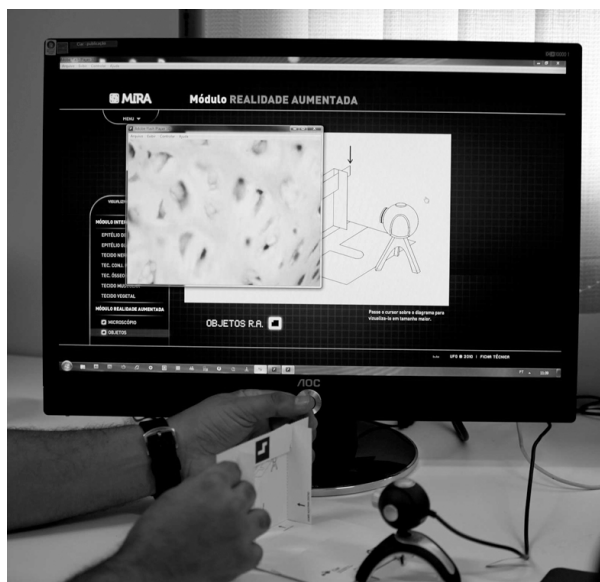
Figura 4. Módulo R.A. com a representação da lâmina. Na tela o que aparece é a imagem “interpretada” e que, para o usuário, é a ampliação do objeto
