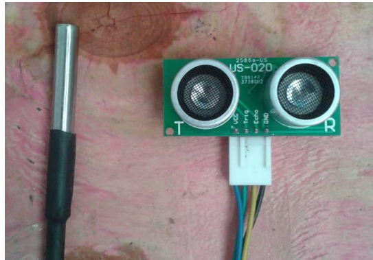
Figura 6. Sensores de temperatura (esquerda) e ultrassom (direita)
