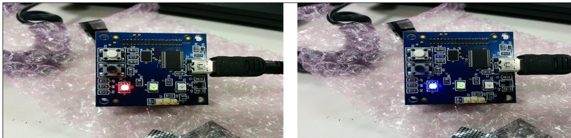
Figura 10: Epos-mote do condicionador de ar indicando que a temperatura alterada
