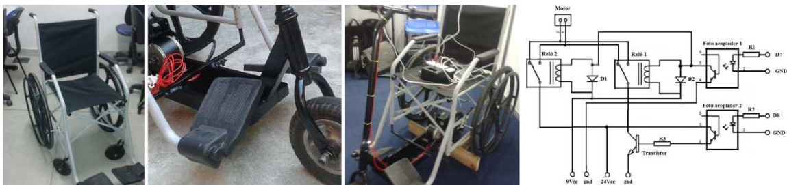
Figura 1. O desenvolvimento gradativo do protótipo e o circuito utilizado.
