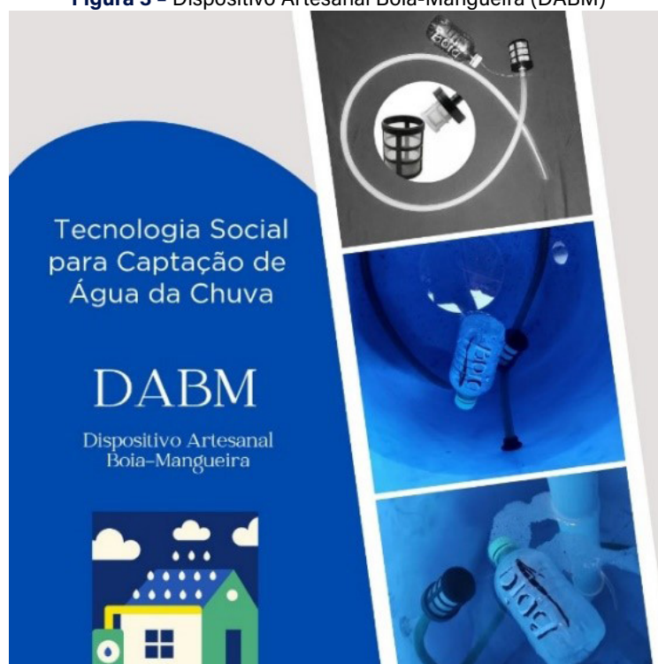
Figura 3 - Dispositivo Artesanal Boia-Mangueira (DABM)
