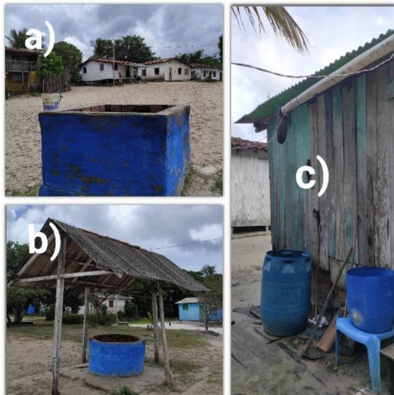
Figura 4 - Poço do tipo Amazonas: a) quadrado; b) redondo; c) SCAC improvisado
