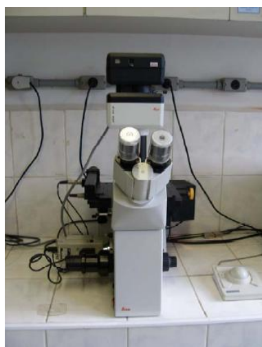
Figura 2. Microscópio óptico Leica DM IRM, com câmera modelo JVC TK-C1480U acoplada, instalado no laboratório de corrosão do IPEN/USP.
